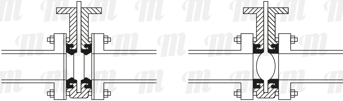
Figura 2: Centrado y rebordeado inicial de la válvula
